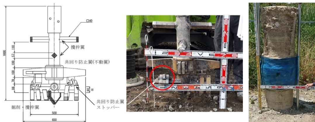
（図-1）拡径部築造機能付掘削攪拌装置と掘り起こした改良体
